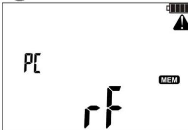
Sie können den Funkübertragungsmodus über die Taste **ESC** verlassen.
